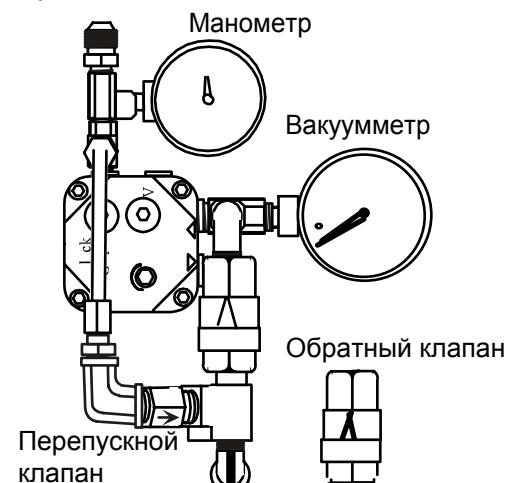
Позволяет подачу лишь в одном направлении. Проверьте на предмет закупорки.
