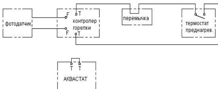
Схема электрическая EL375B, EL500B.
